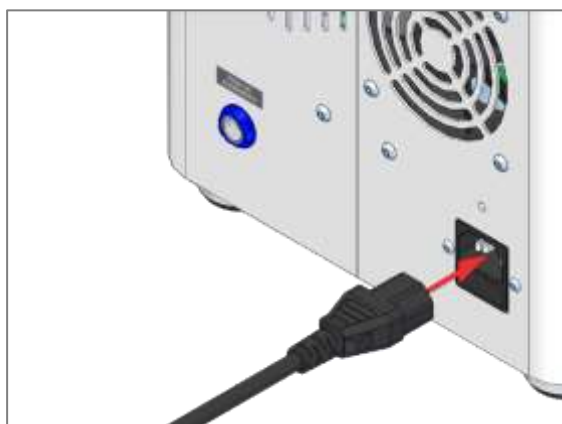
Conexão do Cabo de alimentação
